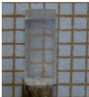
**Exzentrische Kristalle:**  $2 \times 2 \times 5 \text{ mm}^3$  große  $\text{NaI}_3\text{O}_8$ -Einkristalle (siehe Bild) mit azentrischer Struktur wurden hergestellt. Die Kristalle sind bis  $12.5 \mu\text{m}$  lichtdurchlässig, sodass sie die drei atmosphärischen Transparenzfenster abdecken, und sie zeichnen sich durch eine intensive zweite Oberschwingung und einen hohen Schwellenwert gegen optische Schädigung aus.
